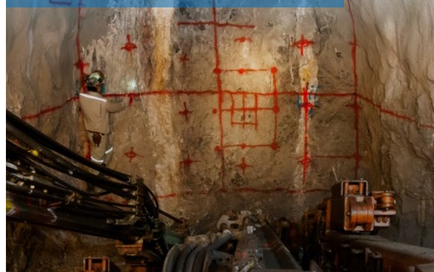
坑内の様子、白い縦筋が金鉱脈
