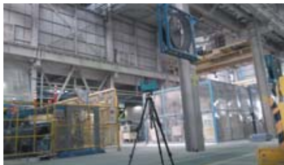
▲粉じん対策の送風機と測定用の粉じん計（中央） 粉じんの発生源はシートで囲っている。
