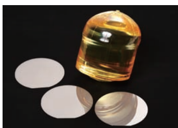
LT基板（結晶とウェハ） LT：タンタル酸リチウム
