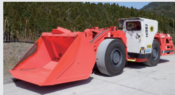
自動運転・遠隔操作試験用の重機
